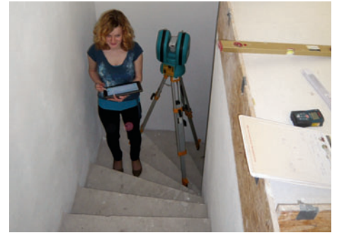
/ 3D-Laserscantechnologie liefert auch bei komplexen Räumen minutenschnell hochpräzise Daten.
