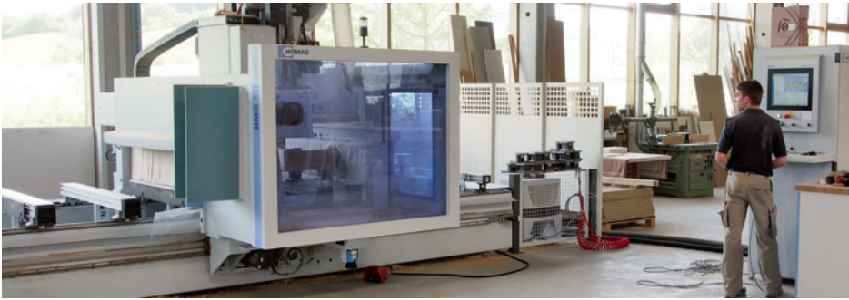
/ Dreh- und Angelpunkt in der Fertigung ist das Fünfachs-Bearbeitungszentrum BMG 511 von Homag. Mit einer Bearbeitungslänge von 6200 mm bietet es umfassende Fertigungsoptionen, nicht nur für Treppen.
